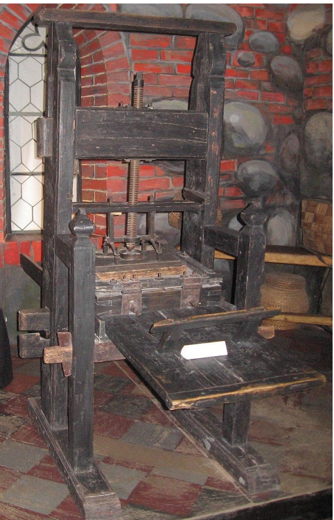
Друкарський станок Гутенберга (реконструкція)
